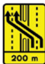
ST5 - Desvio para a faixa de rodagem contrária
